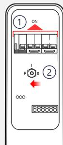
**1** **Accendere la/le batteria/e:** Portare su ON il sezionatore della batteria
